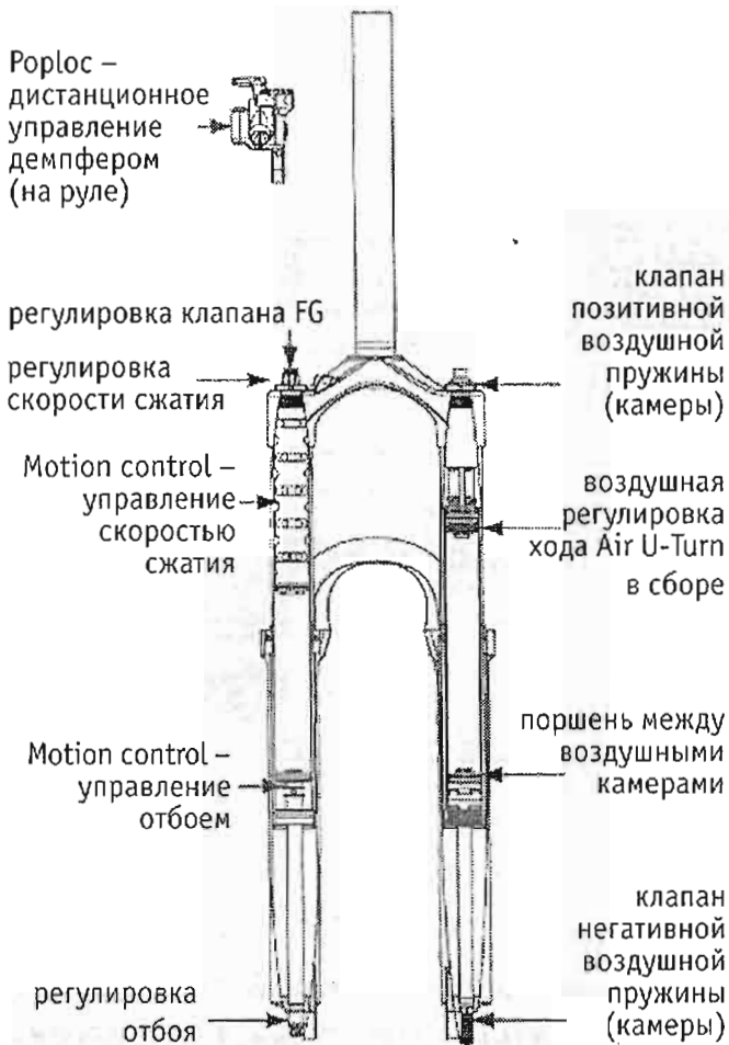
Рис. 3.83. Устройство вилки REVELATION от RockShox
