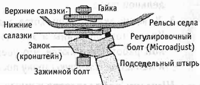
Рис. 3.44. Подседельный двухболтовый штырь
