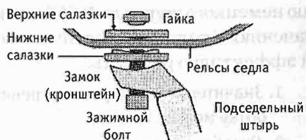
Рис. 3.43. Подседельный одноболтовый штырь
