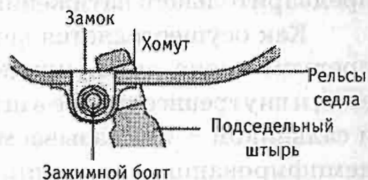
Рис. 3.42. Съемный замок седла
